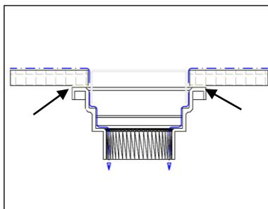
4. Colar um pedaço do piso de sua preferência na medida interna da subtampa montada com silicone ou argamassa:
