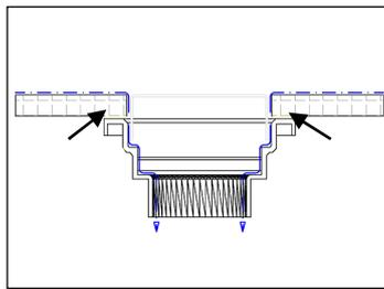
4. Colar um pedaço do piso de sua preferência na medida interna da tampa montada com silicone ou argamassa:
