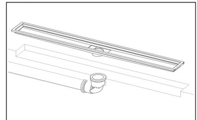
3. Entre o revestimento e as abas isolar com silicone ou rejunte epóxi:
